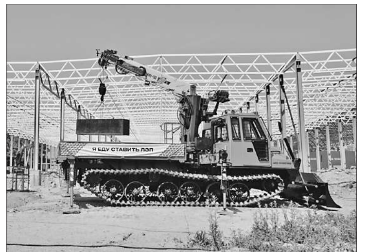
Многофункциональная машина для установки ЛЭП российского производства. Фото rosspetsmash.ru
